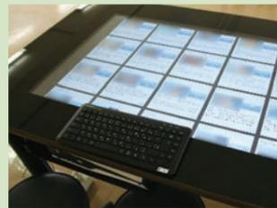
液晶画面を机に組み込んだタッチパネル型3Dバーチャル解剖台に、解剖のエキスパートが執刀した実際の画像がリアルに映し出されます。画面を操作することにより、皮膚から骨に至るまで人体の各層を、見たい方向、見たい深度で、立体的に観察できます。
