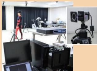
指標となる体の部位（各関節点など）に貼付した赤外線反射マーカーを複数台の赤外線カメラで撮影することにより、正確に身体動作を計測・解析します。床に埋設した床反力計のデータと合わせて、各関節に加わる力を分析することもできます。
