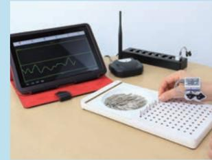
体の表面にセンサーを取り付けると、その筋に生じている電気刺激を瞬時にキャッチし、モニターに映し出します。これにより、手の筋肉の収縮状態を量的、時間的に解析できます。動作解析装置や足圧計測装置とともに、運動学や運動力学、筋電図学を学ぶ際に使用します。
