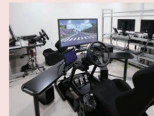
実験室に多様な走行環境を生成し、自動車の運転・走行をシミュレートします。視力やコントラスト感度が低下する白内障や、視野が狭くなる緑内障といった疾患の運転能力への影響、事故が多発する薄暮時の視機能などを研究します。
